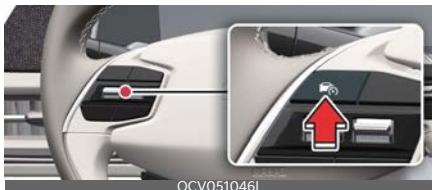
Чтобы включить функцию, нажмите кнопку «Driving Assist» (Помощь при вождении) ( ). Скорость будет установлена согласно текущему значению на приборной панели.
