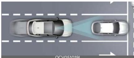
Функция «Forward Collision-Avoidance Assist» (Вспомогательная функция предотвращения лобового столкновения) помогает обнаруживать и отслеживать транспортные средства по ходу движения, обнаруживать пешеходов или велосипедистов на проезжей части, а также предупреждает водителя о возможном столкновении с помощью предупреждающего сообщения и звукового оповещения и применения экстренного торможения.
