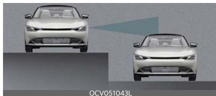
Вспомогательная система предотвращения столкновений в слепой зоне может работать некорректно при движении в местах, где полосы расположены на разной высоте. Система предотвращения столкновений в слепой зоне может не обнаруживать автомобили, движущиеся по дорогам с разной высотой полос. Во время вождения будьте внимательны и следите за дорожными условиями.
