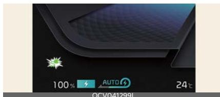
8. После начала зарядки на приборном щитке в течение приблизительно 1 минуты отображается расчетное время зарядки.
