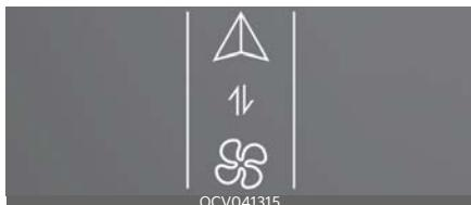
Кнопка на переключаемом контроллере позволяет переключаться между информационно-развлекательной системой и панелью климат-контроля.
