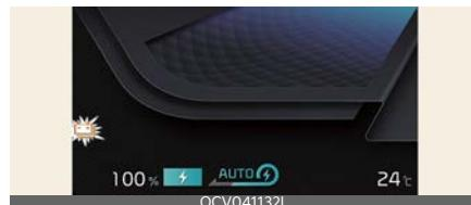
Когда оставшийся уровень заряда опускается ниже 10% на указателе SOC, включается сигнальная лампа (✉), которая предупреждает вас об уровне заряда аккумулятора.
