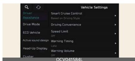
для настройки функций помощи при вождении выберите **Настройки** → **Автомобиль** → **Помощь при вождении** на экране информационно-развлекательной системы.
