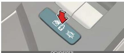
Кроме того, если будет обнаружено приближающееся сзади транспортное средство, когда устройство блокировки замка для защиты детей находится в положении «LOCK» (Блокировка), блокировка замка для защиты детей не будет снята для предотвращения открытия задних дверей, даже если водитель нажмет кнопку разблокирования.
