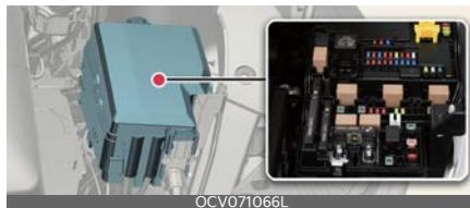
Если не работает пластинчатый плавкий предохранитель, извлеките его с помощью специального зажима, предназначенного для замены предохранителей, который расположен в блоке предохранителей моторного отделения. После извлечения установите запасной предохранитель аналогичного номинала.
