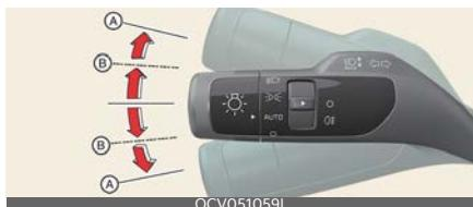
Функция помощи при смене полосы движения на автостраде работает, если нажать рычаг указателя поворота вверх или вниз, когда функция
