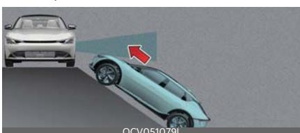
Функция предотвращения столкновений с объектами, движущимися в поперечном направлении позади автомобиля, может быть ограничена при движении автомобиля на подъеме или спуске (или рядом с ними) и может не обнаружить транспортное средство, приближающееся из слепой зоны. Если это произойдет, функция может не предупредить водителя или не применить тормоза, когда это будет необходимо.
