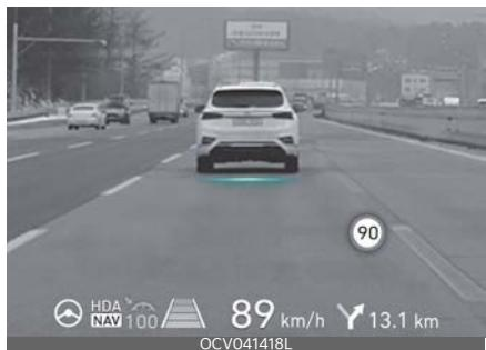
Проекционный дисплей проецирует приборную панель и информацию о навигации на переднее лобовое стекло.
