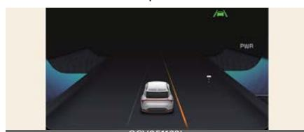
Система удержания на полосе включает подсистему предупреждения о выезде за пределы полосы движения и подсистему для управления автомобилем в пределах полосы.
