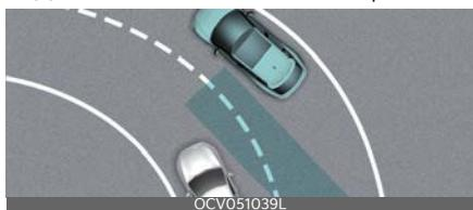
Вспомогательная система предотвращения столкновения в слепой зоне может работать некорректно при движении по извилистой дороге. Система предотвращения столкновения в слепой зоне не всегда обнаруживает транспортные средства в соседней полосе.
