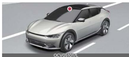
Камера переднего вида используется для определения стиля вождения и обнаружения отъезда транспортного средства впереди во время движения автомобилей.
