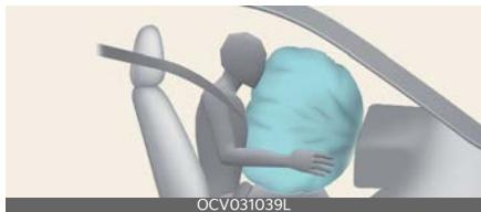
Модули подушек безопасности располагаются по центру рулевого колеса и в передней панели над перчаточным ящиком, напротив пассажира. Если модуль SRSCM регистрирует сильный удар в переднюю часть автомобиля, то автоматически срабатывают подушки безопасности.
