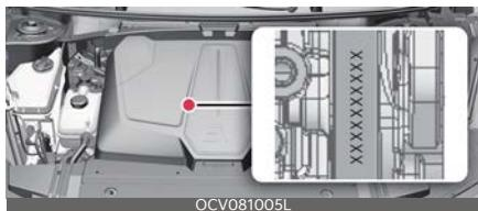
Номер электродвигателя выбит на двигателе (см. рисунок).
