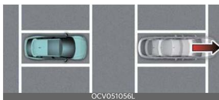
При отъезде припаркованного рядом с вами автомобиля, функция контроля отъезда впереди стоящего автомобиля может предупредить вас о том, что припаркованный автомобиль начинает движение.
