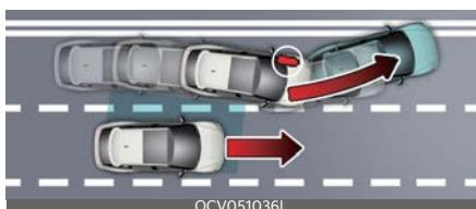
Если при перестроении существует риск столкновения с приближающимся транспортным средством в слепой зоне, функция предотвращения столкновений в слепой зоне поможет избежать данного столкновения, определив полосу движения впереди автомобиля и применяя торможение.
