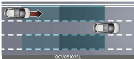
Вспомогательная система предотвращения столкновений в слепой зоне обнаруживает приближающийся на высокой скорости автомобиль в слепой зоне и предупреждает об этом водителю.
