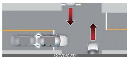
Функция Junction Crossing (Проезд перекрестка) применяет экстренное торможение, чтобы при проезде перекрестка избежать столкновения со встречными транспортными средствами, движущимися слева или справа.
