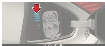
Если установлена запланированная зарядка и подключено зарядное устройство переменного тока или переносной зарядный кабель (ICCB: кабель со встроенным блоком управления), индикаторная лампа мигает (в течение 3 минут), указывая на установку запланированной зарядки.
