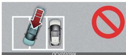
Если при использовании интеллектуальной системы дистанционной парковки другой автомобиль находится только с одной стороны, ваш автомобиль может пересечь парковочную линию во избежание столкновения.
