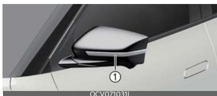
**1** Боковой повторитель указателя поворота (светодиодная лампа)
