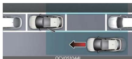
Если после остановки автомобиля и открытия пассажирской двери будет обнаружено приближающееся сзади транспортное средство, система контроля безопасного выхода предупредит водителя с помощью сообщения и звукового сигнала, чтобы предотвратить столкновение.
