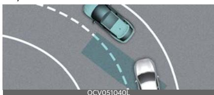
Вспомогательная система предотвращения столкновения в слепой зоне может работать некорректно при движении по извилистой дороге. Система предотвращения столкновения в слепой зоне не всегда обнаруживает транспортные средства в той же полосе.
