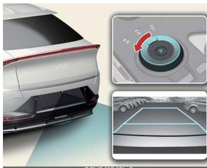
Камера заднего вида отображает область позади автомобиля для помощи в выполнении маневра парковки и движении задним ходом.
