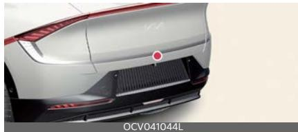
В качестве датчика для обнаружения пешеходов используется камера заднего вида. Если объектив покрыт снегом, каплями дождя и т. п., это может отрицательно повлиять на работу камеры, и система предотвращения столкновения при парковке задним ходом будет работать некорректно. Всегда следите за чистотой объектива камеры.
