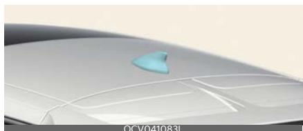
Антенна на крыше передает и принимает беспроводные сигналы, например AM/FM, DAB, GNSS, LTE и т. д.
