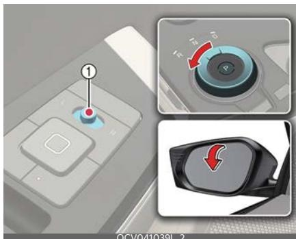
Во время парковки задним ходом наружное зеркало заднего вида опускается при переводе автомобиля в режим «R (Reverse)» (Назад).
