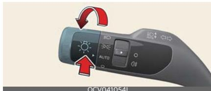
Система автоматического переключения фар дальнего света — это функция, которая автоматически регулирует дальность света фар ( осуществляет переключение между режимами ближнего и дальнего света фар) в зависимости от яркости света от других автомобилей и дорожных условий.
