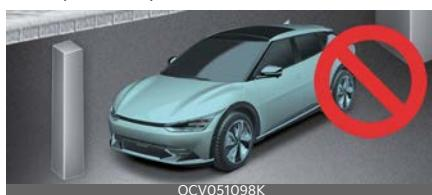
Эффективность работы интеллектуальной системы дистанционной парковки может снизиться или может произойти столкновение, если рядом с парковочным местом находится узкий столб, круглая тумба, квадратный столб или столб с окружающими его объектами (например, пожарный гидрант и т.п.). Водителю следует припарковать автомобиль самостоятельно.
