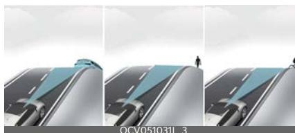
«Forward Collision-Avoidance Assist» (Вспомогательная функция предотвращения лобового столкновения)
