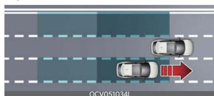
Вспомогательная система предотвращения столкновений в слепой зоне обнаруживает автомобиль в непротивоположной полосе в непротивоположной зоне и предупреждает об этом водителю.
