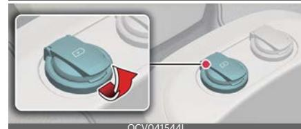
Зарядное устройство USB позволяет водителю и пассажирам заряжать электронные устройства, такие как смартфоны и планшетные ПК.
