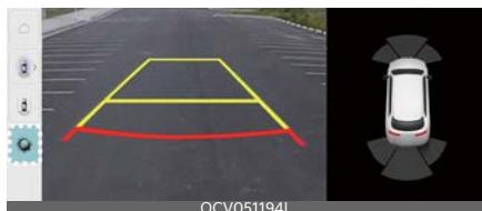
При включенном двигателе выберите значок настройки (⚙) на экране или **Настройки** → **Автомобиль** → **Помощь при вождении** → **Безопасная парковка** → **Настройки камеры** на экране информационно-развлекательной системы, чтобы изменить параметры монитора заднего вида.
