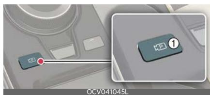
Чтобы включить или выключить монитор заднего вида, нажмите кнопку «Parking/View» (Парковка/обзор) (1).
