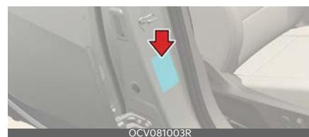
Сертификационная табличка / маркировка шин находится на передней части правой (или левой) стойки "В". На этикетке указан размер ваших оригинальных шин и давление в шинах, необходимое для достижения полной массы вашего автомобиля.
