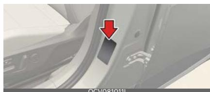
На табличке с информацией о шинах, расположенной на средней стойке (см. рисунок), указывается давление в шинах, рекомендованное для данного автомобиля. Установленные на вашем автомобиле шины выбраны для обеспечения наилучших характеристик управляемости автомобиля.
