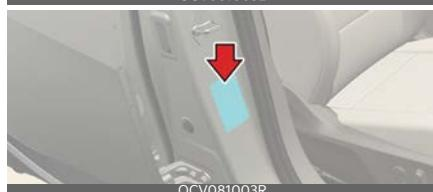
На сертификационной табличке автомобиля, закрепленной на средней стойке (см. рисунок), имеется идентификационный номер автомобиля (VIN).
