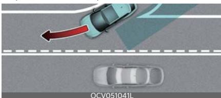
Вспомогательная система предотвращения столкновения в слепой зоне может работать некорректно в местах соединения или разделения дорог. Система предотвращения столкновения в слепой зоне не всегда обнаруживает транспортные средства в соседней полосе.
