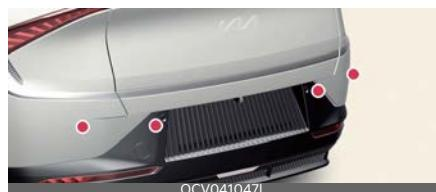
Задние ультразвуковые датчики, расположенные внутри заднего бампера, служат для обнаружения объектов позади автомобиля. Если датчики покрыты снегом, каплями дождя и т. п., это может отрицательно повлиять на работу датчиков, и система предотвращения столкновения при парковке задним ходом будет работать некорректно. Всегда поддерживайте чистоту заднего бампера.
