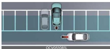
Функция предотвращения столкновений с объектами, движущимися в поперечном направлении позади автомобиля, может обнаруживать транспортные средства, проезжающие сзади вас, когда вы паркуетесь задним ходом на парковочное место. Если это произойдет, функция не всегда может выдавать
