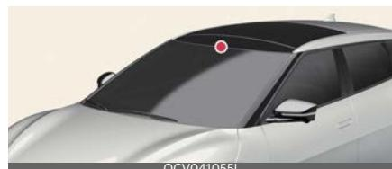
Камера переднего вида используется в качестве датчика обнаружения для определения уровня окружающего освещения и яркости во время управления автомобилем. Смотрите точное расположение датчика обнаружения на иллюстрации выше.
