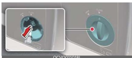
Если зарядный кабель не отсоединен вследствие разряда батареи или неисправности соединительных проводов, откройте дверь багажника и слегка потяните аварийный кабель, как показано выше. Крышка зарядного гнезда откроется.
