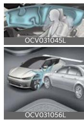
Боковые подушки и/или шторки безопасности раскрываются только при обнаружении удара датчиками бокового столкновения, в зависимости от силы удара, его направления, скорости и точки соприкосновения.
