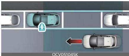
Если после остановки автомобиля и открытия пассажирской двери будет обнаружено приближающееся сзади транспортное средство, система безопасной высадки из автомобиля предупредит водителя с помощью сообщения и звукового сигнала, чтобы предотвратить столкновение.
