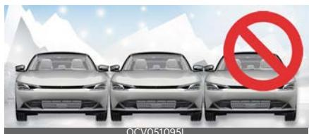
Снег может помешать работе датчиков в процессе парковки, а на скользкой дороге может быть отменена работа интеллектуальной системы дистанционной парковки.
