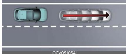
Если впереди стоящий автомобиль резко начинает движение, функция контроля отъезда впереди стоящего автомобиля может работать неправильно.
