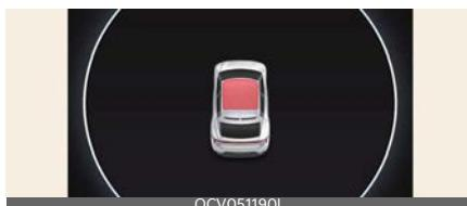
Если выключить двигатель при не полностью закрытом люке в крыше, через несколько секунд начнет зву-
