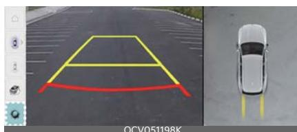
При включенном двигателе выберите значок настройки (⚙) на экране или **Настройки → Автомобиль → Помощь при вождении → Безопасная парковка → Настройки камеры** на экране информационно-развлекательной системы, чтобы изменить параметры монитора заднего вида.
