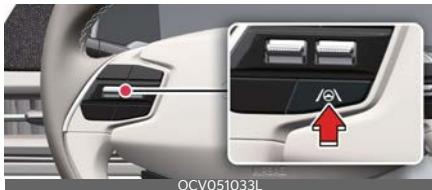
Чтобы включить систему слежения за полосой движения, при работающем двигателе нажмите кнопку «Lane Driving Assist» (Автоматическое удержание на полосе) на рулевом колесе. На приборной панели включится серый или зеленый индикатор (Ⓐ). Чтобы выключить функцию, нажмите кнопку еще раз.
