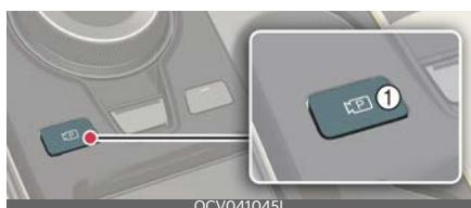
Чтобы включить/выключить монитор кругового обзора, нажмите кнопку «Parking/View» (Парковка/обзор) (1).
