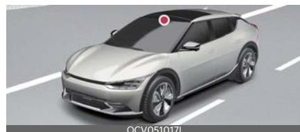
Камера переднего вида используется в качестве датчика обнаружения дорожной разметки и движущихся впереди автомобилей.
