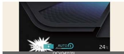
Указатель уровня заряда (SOC) показывает состояние зарядки высоковольтного аккумулятора.
