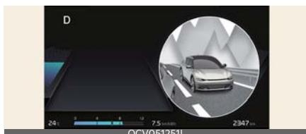
Когда включен сигнал поворота, монитор отображения «слепых зон» отображает на приборной панели заднюю непросматриваемую зону рядом с автомобилем для помощи в безопасной смене полосы движения.
