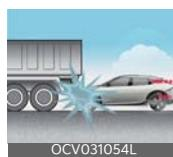
При резком торможении передняя часть автомобиля опускается, из-за чего он «плотнитает» под транспортное средство, имеющее больший дорожный профиль.
