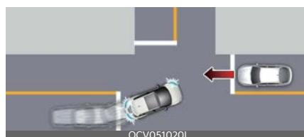
Функция поворота на перекрестке применяет экстренное торможение, чтобы избежать столкновения со встречным транспортным средством на соседней полосе при повороте на перекрестке налево (левый руль) или направо (правый руль) с включенным сигналом поворота.
