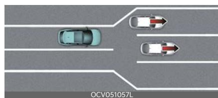
При движении через пункт сбора дорожной пошлины или через перекресток с большим количеством транспортных средств, а также при движении в местах, где полосы часто соединяются и разделяются, функция контроля отъезда впереди стоящего автомобиля может работать неправильно.
