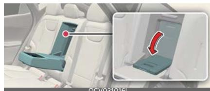
В автомобиле предусмотрено дополнительное пространство для длинных и узких грузов (лыжи, лыжные палки и пр.), которые не помещаются целиком в закрытом багажнике.
