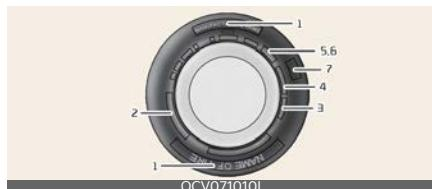
На боковой поверхности нанесена идентифицирующая информация, основные характеристики шины и идентификационный номер шины (TIN), необходимый для сертификации соответствия стандартам безопасности. Номер TIN также может использоваться для идентификации шины в случае отзыва.
