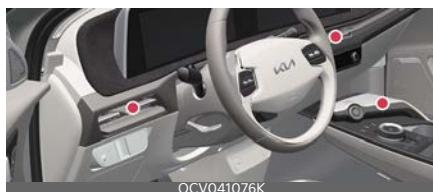
Окружающее освещение установлено в передней амортизирующей накладке, передних дверях и верхней/нижней части центральной консоли.
