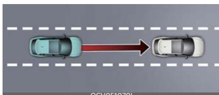
Система «Highway Driving Assist» (Помощь при вождении на автомагистрали) разработана для обнаружения транспортных средств и полос движения и соблюдения дистанции до движущегося впереди транспортного средства, установленной скорости и удерживания автомобиля в полосе движения при движении по автостраде (или шоссе).
