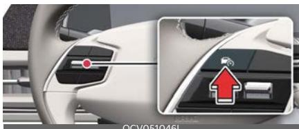
Чтобы отключить систему ручного контроля за ограничениями скорости, нажмите кнопку «Driving Assist» (Помощь при вождении) (☞). Индикатор ограничения скорости (☞ LIMIT) погаснет.
