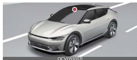
Камера переднего вида используется в качестве датчика обнаружения для определения дорожной разметки (или обочины).
