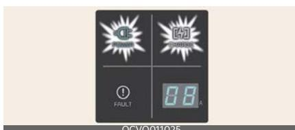
9. Убедитесь, что индикаторная лампа (⚡) зарядки высоковольтного аккумулятора на приборной панели включена. Зарядка не происходит, если индикатор зарядки (⚡) выключен. В случае неправильной или неполной вставки разъема в гнездо, отсоедините и подсоедините кабель еще раз.
