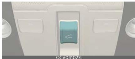
Люком можно управлять, только когда кнопка «Электромобиль» находится в положении «Вкл.» или «Пуск». Люк еще может работать в течение приблизительно 3 минут после перевода кнопки EV в положение «ACC» (Доп. устройства) или «OFF» (Выкл.). Тем не менее, если открыта передняя дверь автомобиля, люком управлять будет невозможно даже в течение периода в 3 минут.
