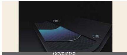
Указатель энергопотребления/заряда отображает интенсивность энергопотребления электромобиля и статус зарядки/разрядки системы рекуперативного торможения.
